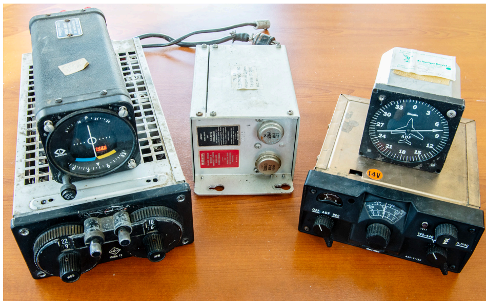
Un système NAVCOM Narco Mark 12 et un système ADF Bendix T-12C, du matériel avionique emblématique de l'aviation générale des années 1960 et 1970 (photo Pierre Gillard).
