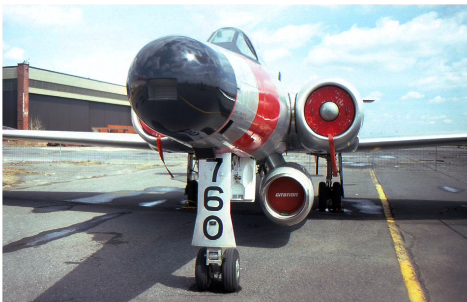
La nacelle du moteur Pratt & Whitney Canada JT15D greffée sur l'Avro CF-100 Canuck #100760 (photos collection Marc Émond).
