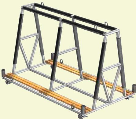
**GSE01** : Chariot destiné à transporter les deux ailes du CF-100. La complexité de la conception du projet réside dans le fait que les ailes sont très lourdes. Chacune pèse, en effet, 1.320 kg ! Bien entendu, le chariot pourra aussi être utilisé pour entreposer et déplacer des ailes d'autres avions.
