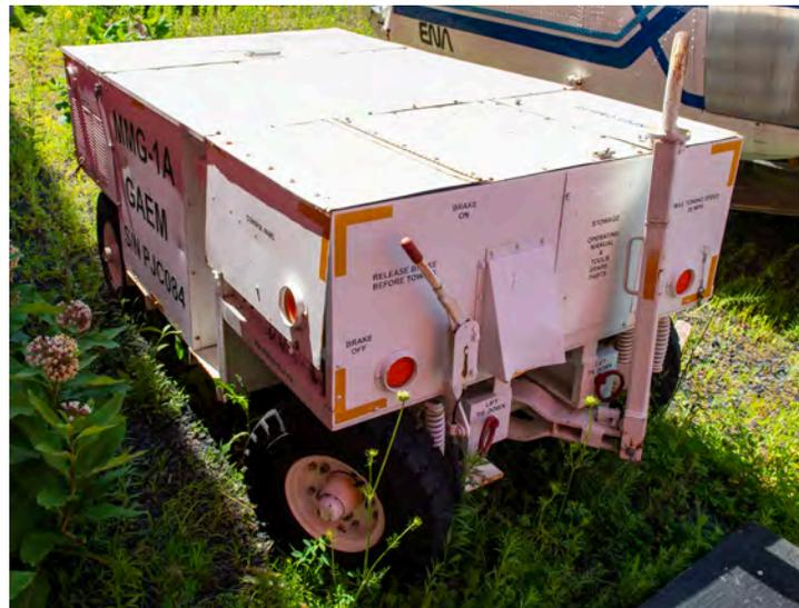
*Ci-dessus à gauche : Chariot permettant de transporter les ailes du CF-100 conçus par des étudiants de l'ÉTS selon un cahier des charges rédigé par le MAQ. Ci-dessus à droite : Un des deux GPU reçus de l'ÉNA. Celui-ci permet une alimentation AC ou DC (image ÉTS et photo Pierre Gillard).*
