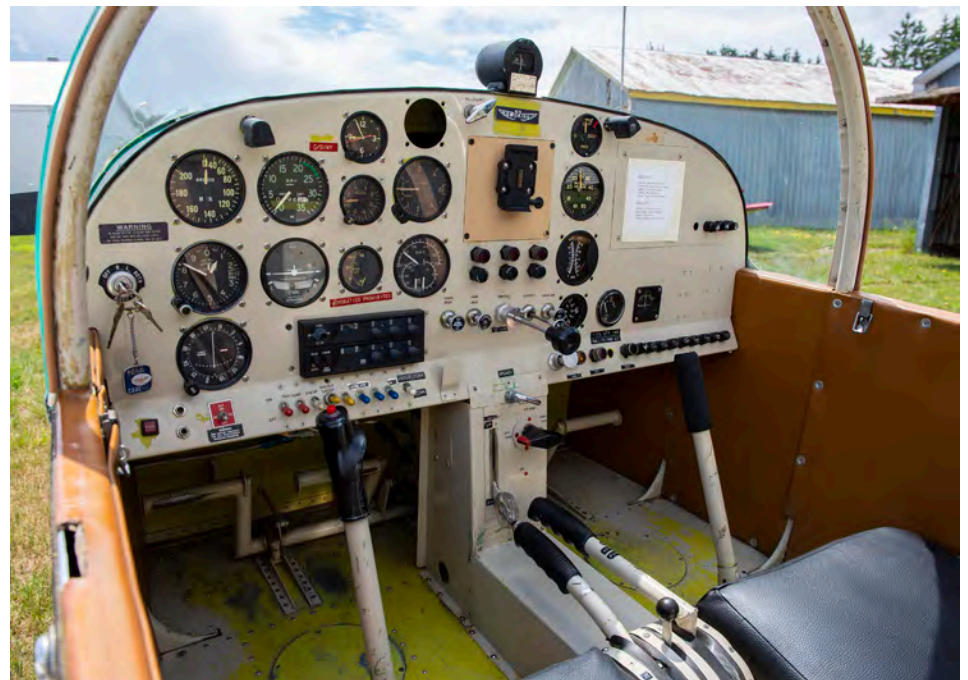
L'instrumentation et l'avionique du tableau de bord sont à la fois limitées et suffisantes pour le vol VFR. Un moment donné, un horizon artificiel et un gyroscope directionnel devraient être réinstallés comme à l'origine. Ils avaient été démontés afin d'être remplacés par un GPS (photo Pierre Gillard).
