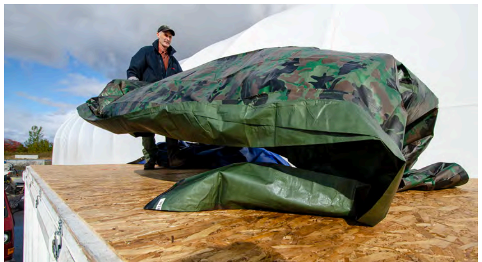
Au milieu : pour éviter que le toit ne s'effondre sur le Flyer à cause de la neige, un madrier a été ajouté. Ci-dessus : Frédéric Morin étend la bâche intermédiaire sur les panneaux d'OSB vissés sur le toit de la caisse (photos Pierre Gillard).
