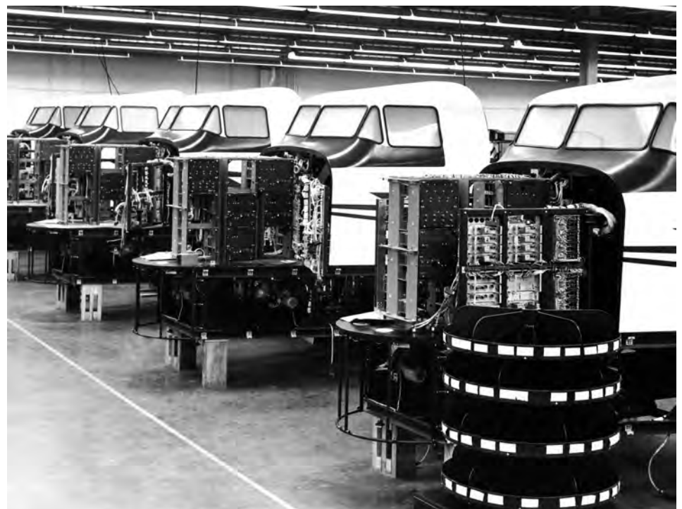
Dans les ateliers de CAE, assemblage final des simulateurs « Twin Engine » destinés essentiellement à l'entraînement des équipages de l'Aviation royale canadienne volant sur les bimoteurs de l'époque (photo CAE, collection CANAV Books).
