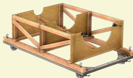
**GSE03** : Dispositif accessoire permettant de transporter l'empennage du CF-100 sur un chariot universel GSE02. Pour des raisons de facilité de réalisation et de recyclage, il est conçu en bois.
